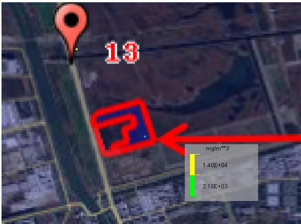
图 5-8 甲苯储罐泄漏最常见气象条件下预测结果示意图
