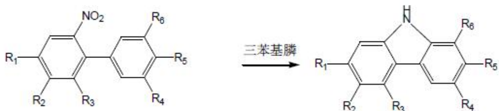
图 3.17-9 硝基关环相关工艺路线图
